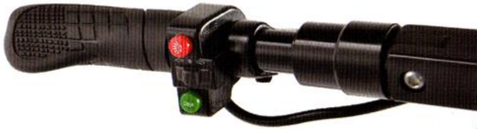
Luz frontal, interruptor de velocidad (izquierda lenta, derecha rápida), bocina
